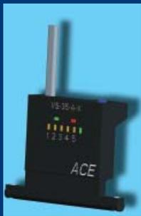
permanent im Arbeitsprozess entstehende Vibrationen bzw. Belastungen auf. Steigen diese durch Überlastungen, schwankende Antriebs- oder nachlassende Bremsleistung über die voreingestellten Sollwerte hinaus an, schaltet der Sensor. Über eine Anbindung an das Condition Monitoring System wird der Arbeitsprozess unterbrochen. Teure Reparatur- und Wartungskosten können so vorbeugend vermieden werden.
